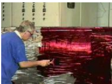
Líquido penetrante sendo aplicado
