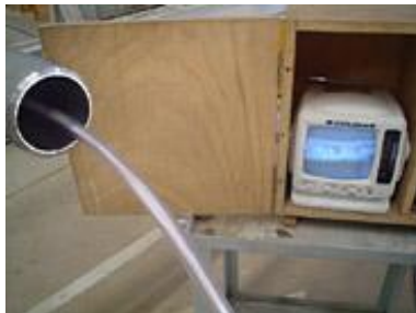
Inspeção com auxílio de micro-câmera
