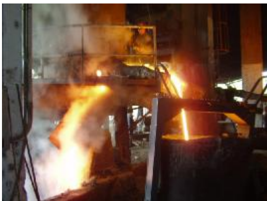
Metal líquido sendo vazado na panela
