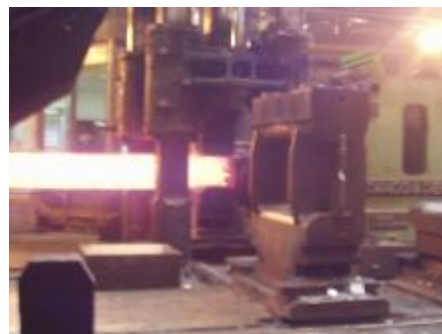
Lingotes no processo de forjamento
