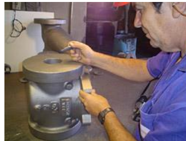
Inspeção visual em fundido
