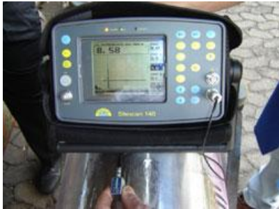
Ensaio com cabeçote angular
